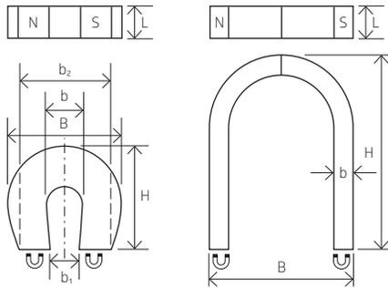
Zum Prüfen von Werkstoffen und Herausheben von Kleiseisenteilen.
