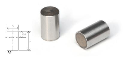
Beim direkten Einbau des Magnetsystems in Eisen kommt es zu einer Haftkraftverringerung von bis zu 15 % durch magnetische Kurzschlüsse. Um dies zu vermeiden, müssen bestimmte Abstände vom Messingmantel des Magnetsystems zum Eisen eingehalten werden. Die Abstände zum Eisen sind auch einzuhalten, wenn das Magnetsystem um das Maß KM gekürzt wurde. Die empfohlenen Abstände entnehmen Sie bitte den Tabellen (Abstand mm).
