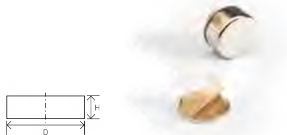
Scheibenmagnet, Neodym-Eisen-Bor (NdFeB) Magnetisiert über Maß H (axial), Einsatztemperatur max. 80\text{ °C}
